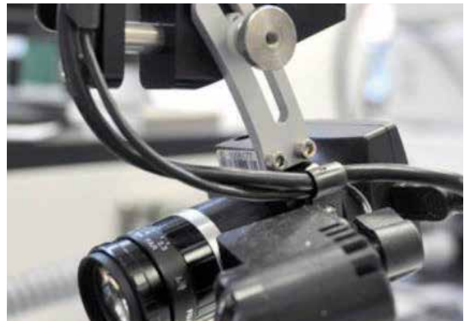
Lötprozesskontrolle mittels Schwenkkamera © Finetech GmbH & Co. KG
