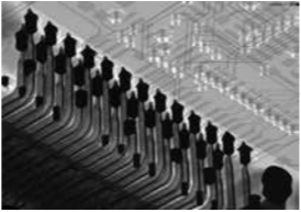
X-Ray-Untersuchung nach Lötprozess
